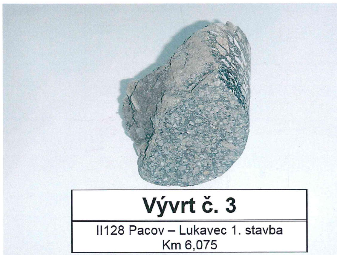
Foto č. 4 – Detail vývrtu č. 3
