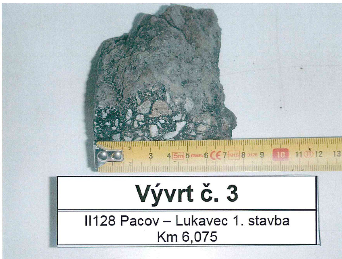
Foto č. 3 – Detail vývrtu č. 3
