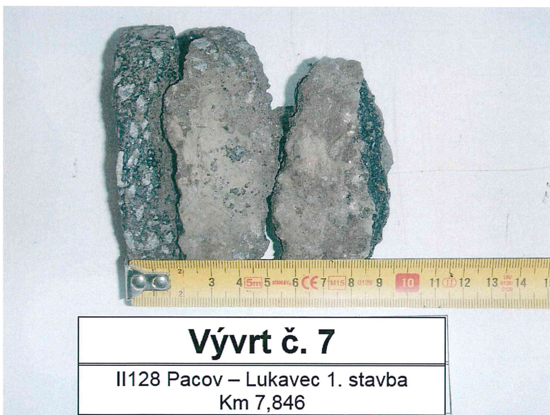
Foto č. 8 – Detail vývrtu č. 7
